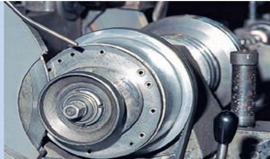
Führungsaufgaben: Links ist die Stahlscheibe zu sehen, die den Meisternocken „abtastet“...
