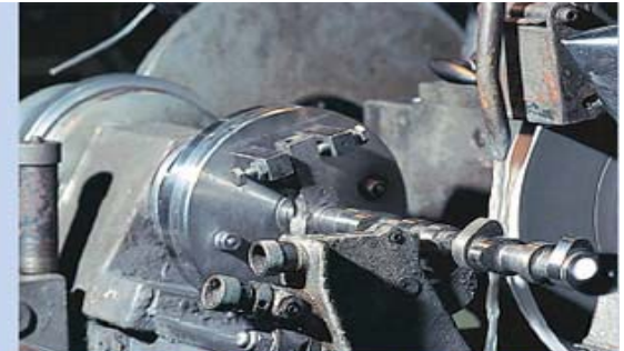
...und dafür sorgt, dass der beschädigte Nocken exakt auf dessen Form geschliffen wird
