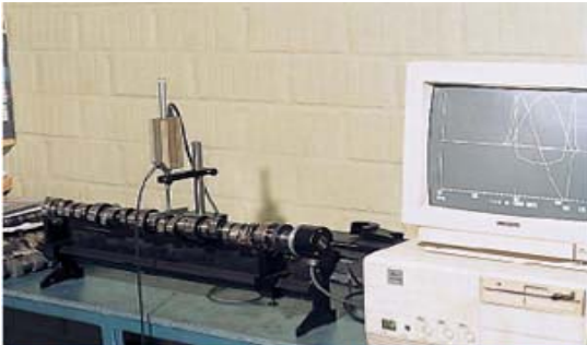
So sieht's beim Profi aus: Der Meisternocken wird auf einer Meßbank per Computer ausgewählt
