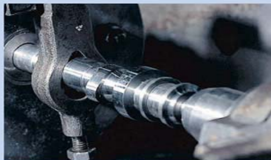
Aufwendig: Erst werden die Lagerstellen, dann die Nocken aus dem Rohling herausgearbeitet
